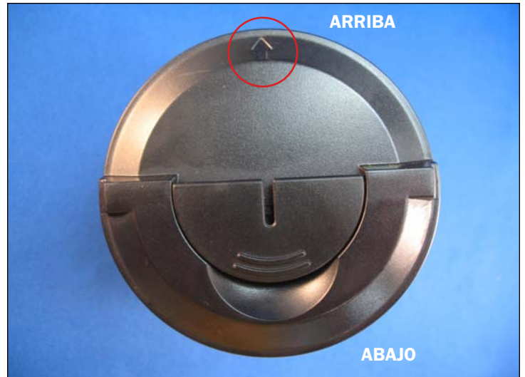
4. Vista cercana de la flecha grabada en el frente del cartucho apuntando hacia arriba. Esta es la posición del mismo al ser insertado en la impresora.
