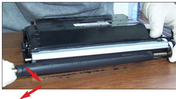
8. Deslizar el rodillo hacia afuera del cartucho.
