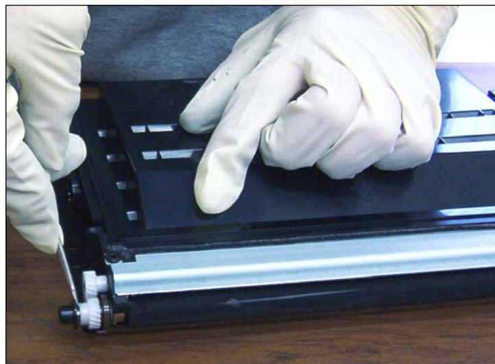
6. Sacar el clip metálico con ayuda de un pequeño desarmador plano. Sacar el clip hacia arriba para apartarlo del eje.
