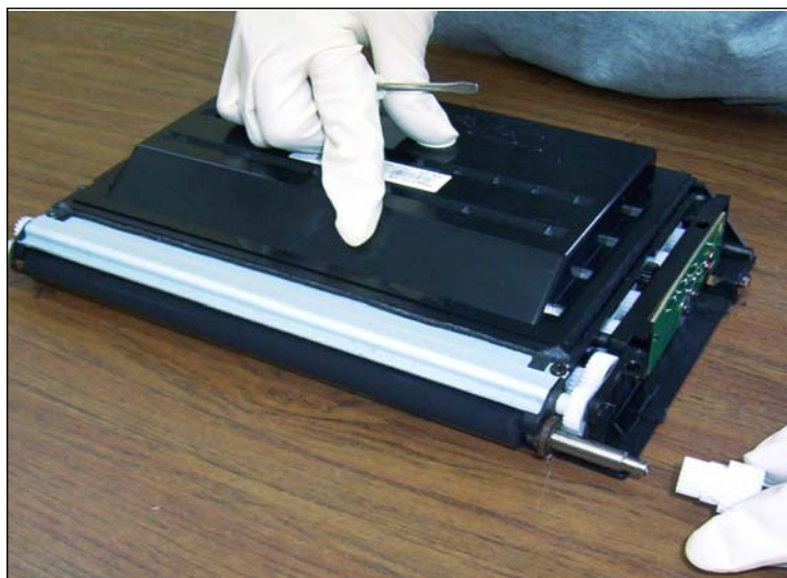
5. Sacar los engranajes de cada lado. Deben salir fácilmente.
